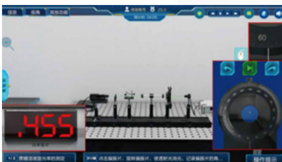
Bestimmung der optischen Rotation einer Saccharose-Lösung
