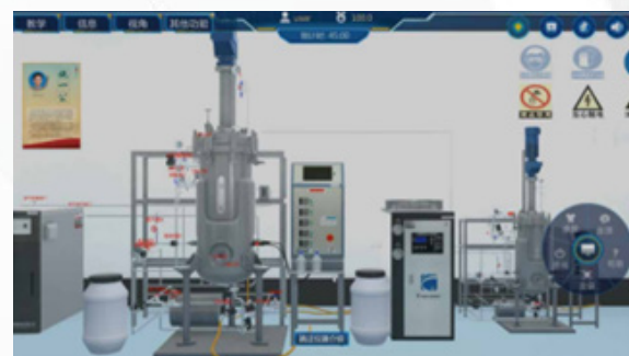
Pilot-Skalierung im 100 L Fermenter
