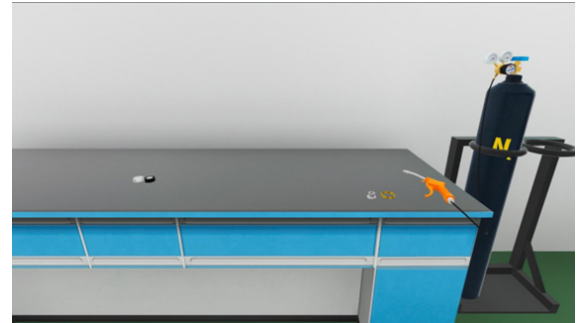
Reinigen der galvanisierten Bauteile
